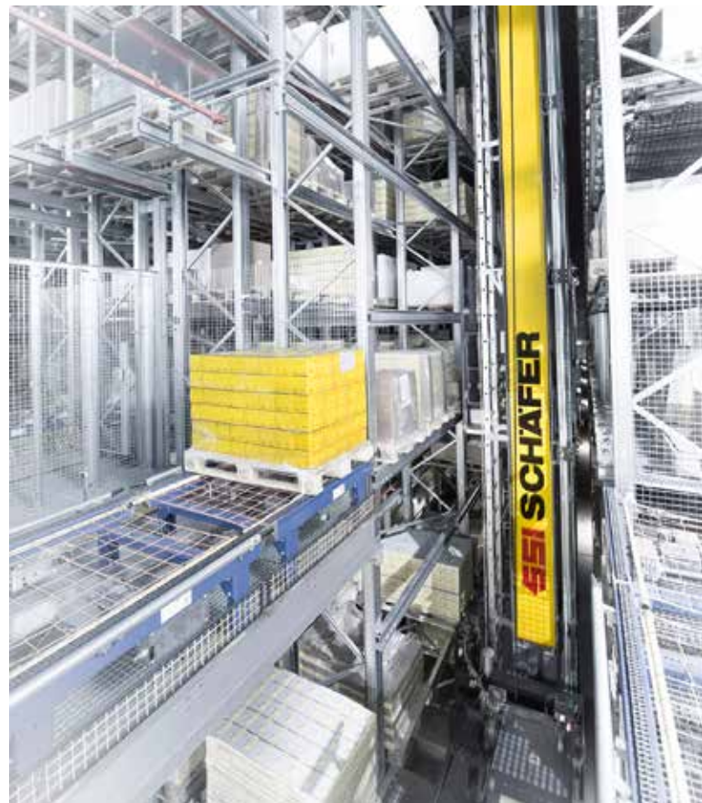
In alto: SSI EXYZ, il trasloelevatore per lo stoccaggio automatico di pallet e unità di carico di grandi dimensioni. In basso: SSI FLEXI, shuttle monolivello per lo stoccaggio di un'ampia varietà di unità di carico (cassette, scatole, vassoi ecc.)
