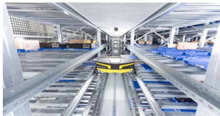
In alto: SSI EXYZ, il trasloelevatore per lo stoccaggio automatico di pallet e unità di carico di grandi dimensioni. In basso: SSI FLEXI, shuttle monolivello per lo stoccaggio di un'ampia varietà di unità di carico (cassette, scatole, vassoi ecc.)
