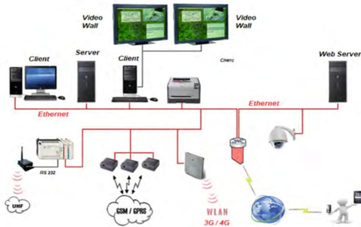
supervisione che servono per rendere il nodo tele-gestibile da una stazione PC SCADA remota attraverso il supporto di comunicazione GSM, di facile utilizzo ed ampia diffusione, affidabile ed a basso costo.
