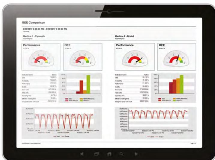
Con zenon è possibile comparare l'efficienza di due macchine installate in stabilimenti produttivi differenti
