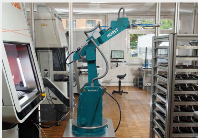
Il robot industriale "Horst" di Fruitcore Robotics carica e scarica la Stazione di Marcatura Laser FOBA M3000 presso l'Azienda di servizi medicali di Marcatura Laser Add'n Solutions Tuttlingen, Germania. Diritti di immagine: Fruitcore Robotics
