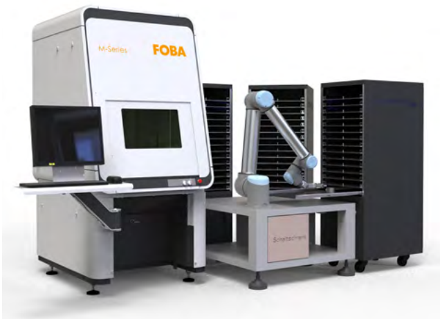
Stazione di Marcatura Laser FOBA M2000 e il cobot industriale Zeltwanger integrato nel processo di Marcatura Laser. Diritti di immagine: ZELTWANGER.
