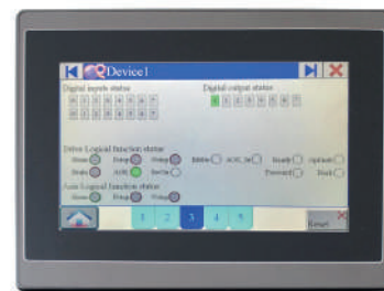
► PT2 HMI qui con una libreria CMZ configurata per flowpacks, packaging
